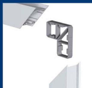
■ Для крепления боковых стоек к основному несущему профилю устанавливаются специальные угловые соединения.
